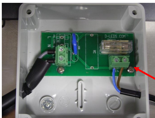
Fig.4 Morsetto per la connessione alla rete elettrica
